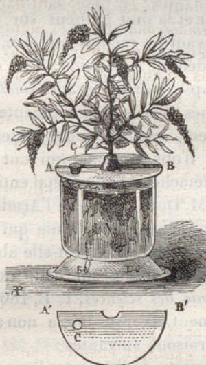
AB. Point de jonction des deux disques. — A'B'. Un des disques isolé. — C. Ouverture pour les arrosages. — E. Support du vase. — F. Trou pour l'écoulement des eaux.
