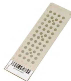
Figure 15 : Plaque 48 cibles fournie avec le Vitek MS (bioMérieux)
