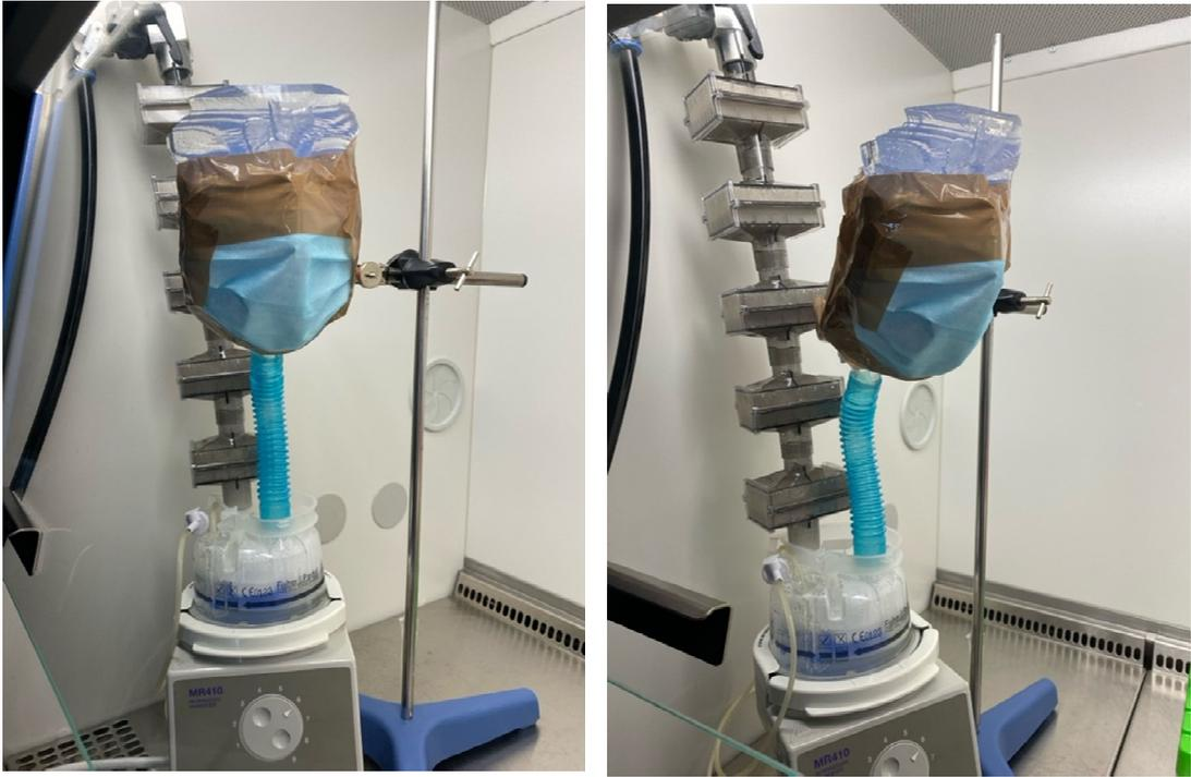
*Figure C : Montage du simulateur avec ajustement du masque en condition « étanche »*
