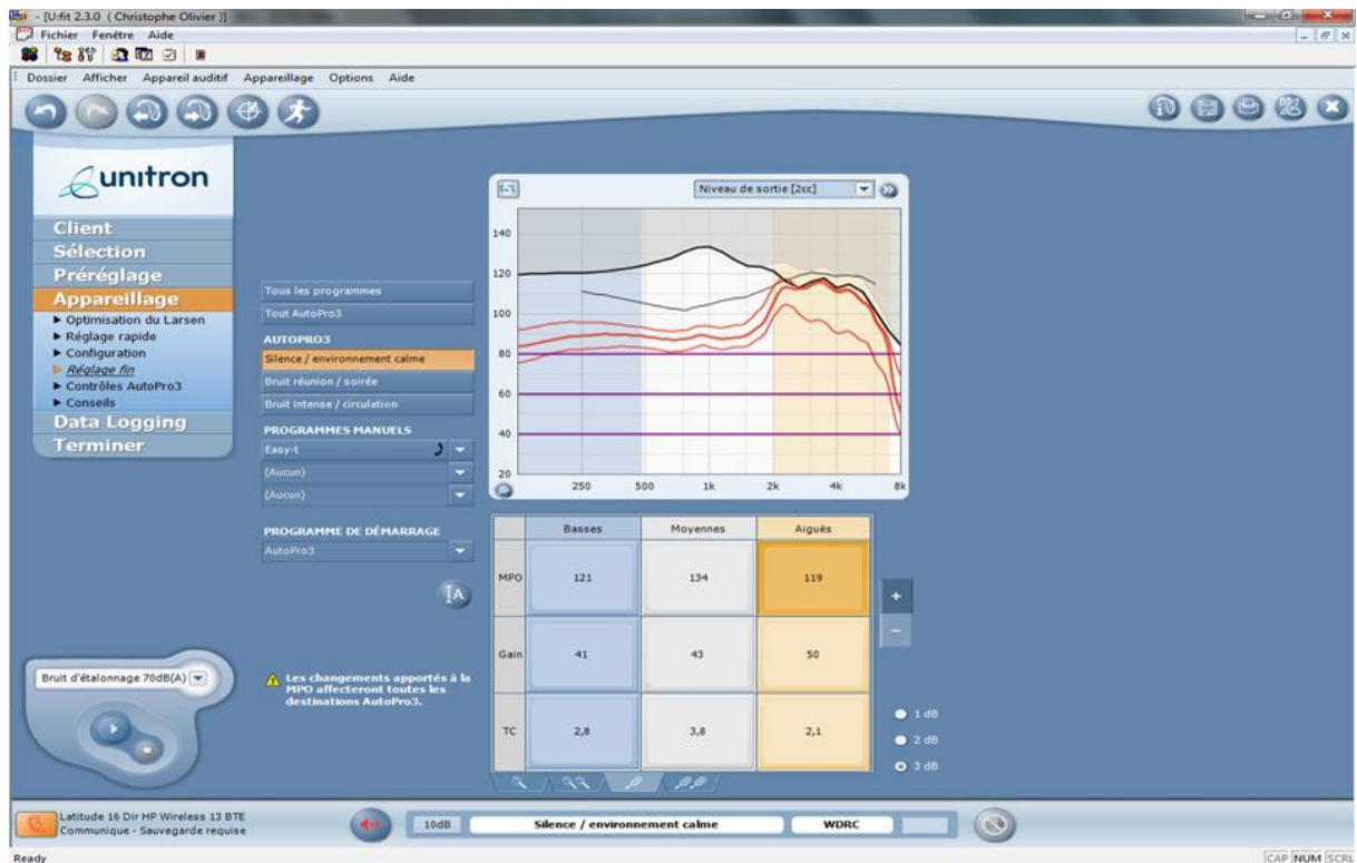
Figure (35) : Affichage du logiciel UNIFIT 2.3.0 d'Unitron présentant les niveaux de sortie en sons purs avec un réglage où les MPO ont été diminués
