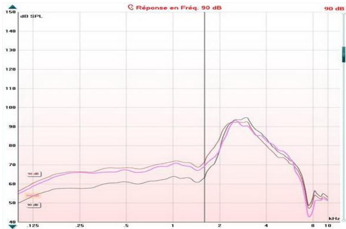
Figure(33) : Figure 29 en ayant ajouté la courbe rose qui représente le niveau de sortie avec la baisse des gains
