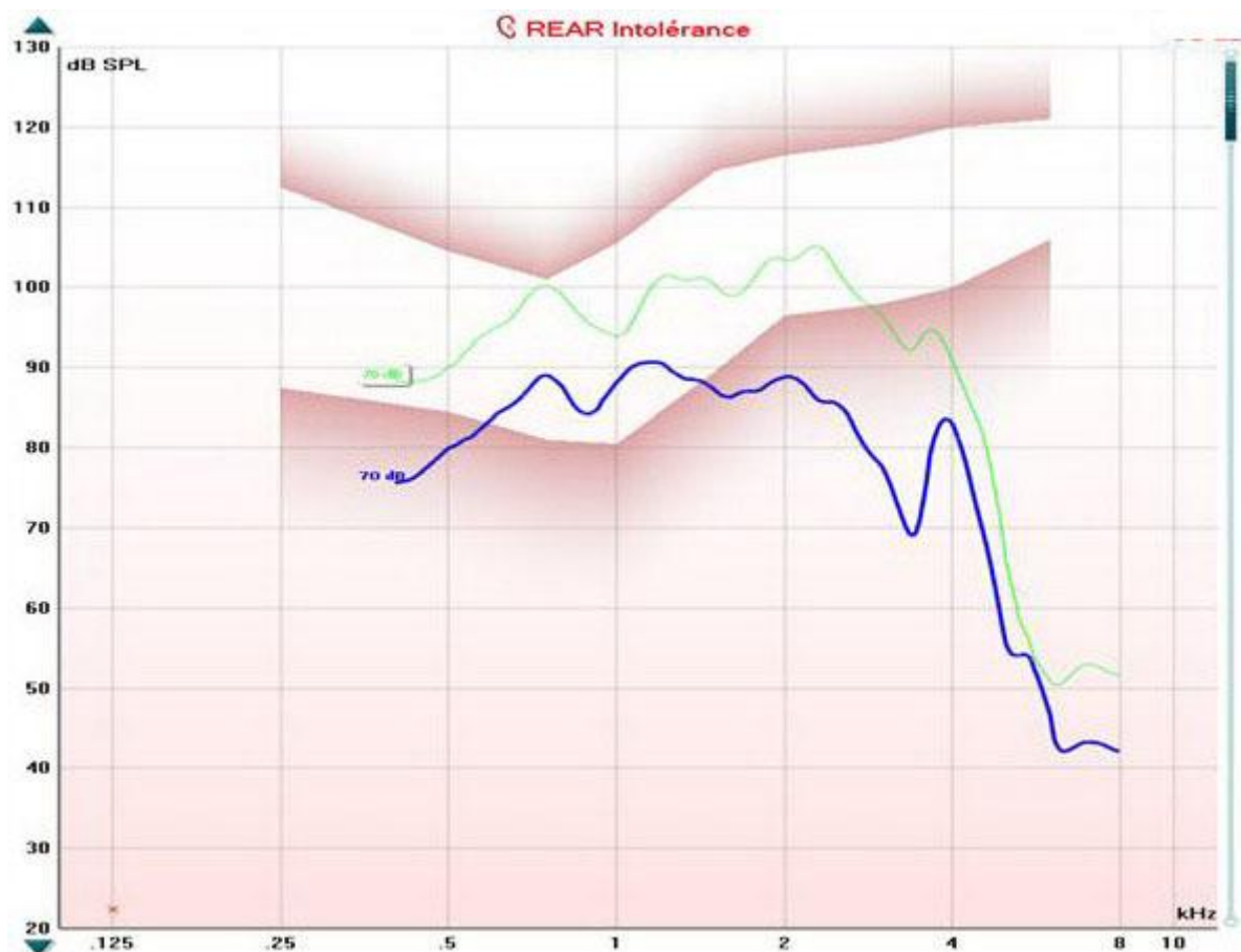
Figure (62) : S.P.L-O-GRAM avec un bruit rose de 70 dB SPL ; la courbe verte est le résultat obtenu à 2 secondes avec un bruit rose et la bleue à 30 secondes
