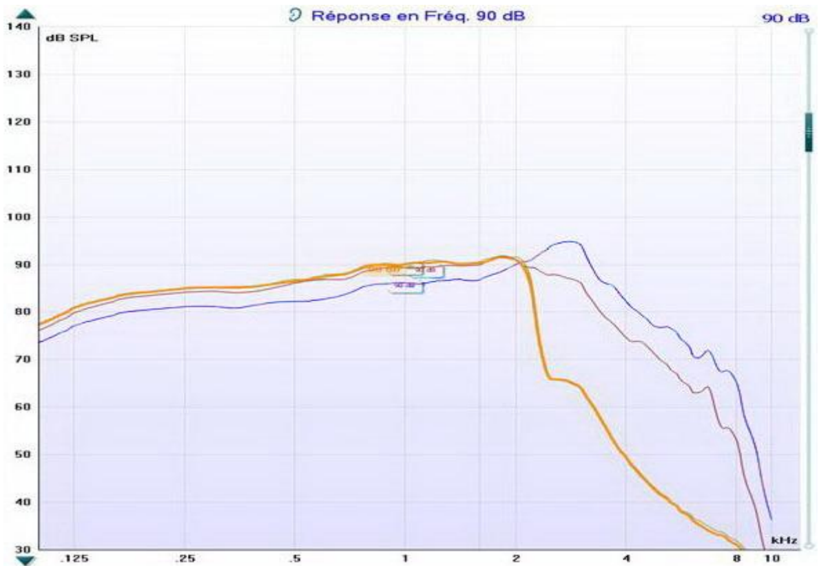
Figure (37) : Niveaux de sortie au coupleur 2cc avec un bruit rose de 90 dB SPL. La courbe orange représente le réglage avec le Soundrecover enclenché, la bleue celui où les gains sont poussés au maximum et la violette celui où l'on a agi en baissant les MPO
