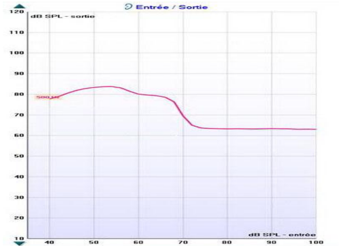
Figure(21) : Courbe de transfert à 500Hz au coupleur 2cc avec un SMART S IX ayant le réglage de la figure 20
