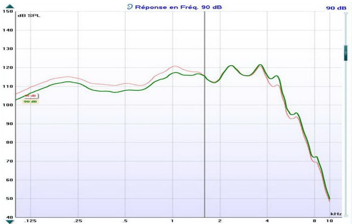
Figure (25) : Niveaux de sortie au coupleur 2cc avec un bruit rose de 90 dB SPL sur le logiciel Connexx v6.4.3.348 où la courbe rose représente le réglage en saturation, la verte après modification du MPO sur la bande de fréquence aigüe
