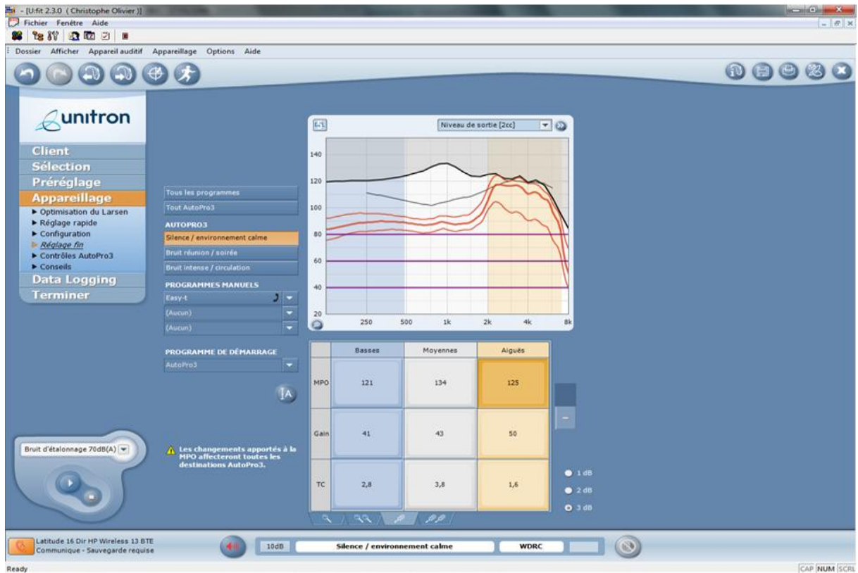
Figure (34) : Affichage du logiciel UNIFIT 2.3.0 d'Unitron présentant les niveaux de sortie en sons purs avec un réglage qui mène à la saturation
