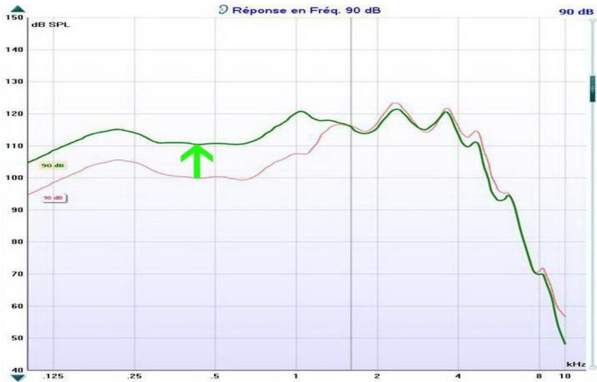
Figure (24) : Niveaux de sortie au coupleur 2cc avec un bruit rose de 90 dB SPL où la courbe rose représente le réglage en saturation, la verte avec la baisse de -3 dB sur les MPO
