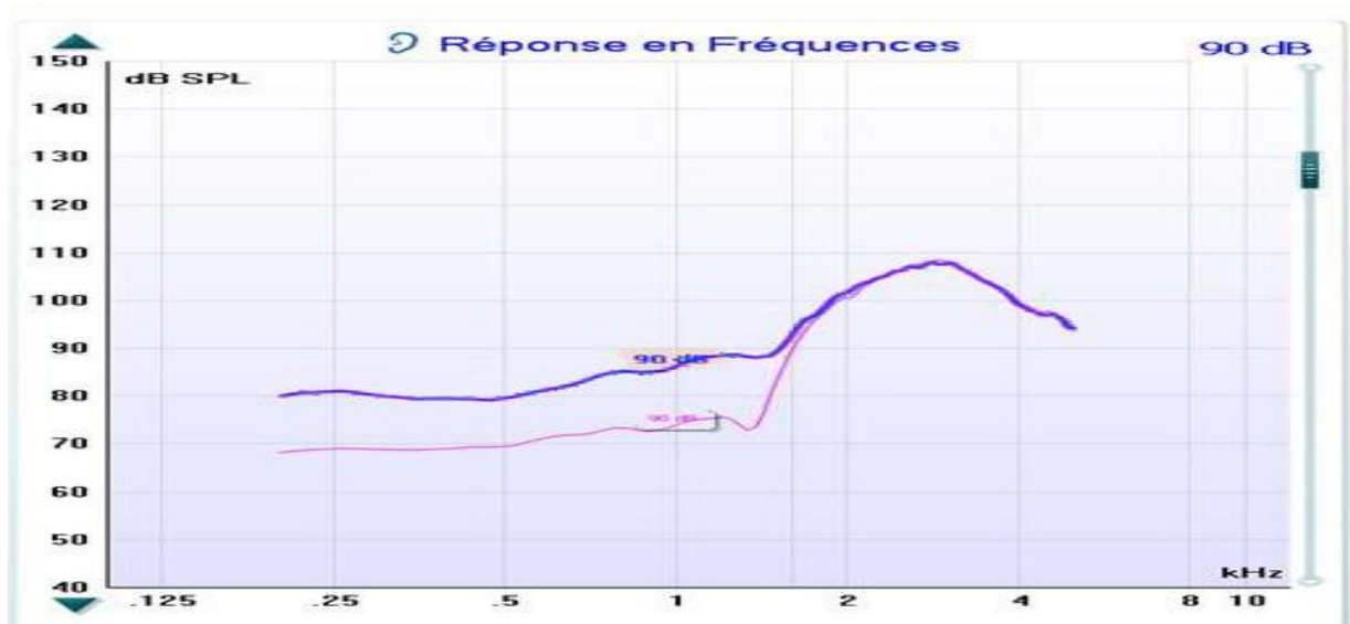
Figure (28) : Niveaux de sortie avec un bruit rose de 90 dB SPL où la courbe bleue représente celle du réglage avec la baisse des MPO, l'autre correspond à celui où les MPO sont au maximum avec un VELVET X-MINI de la marque Hansaton
