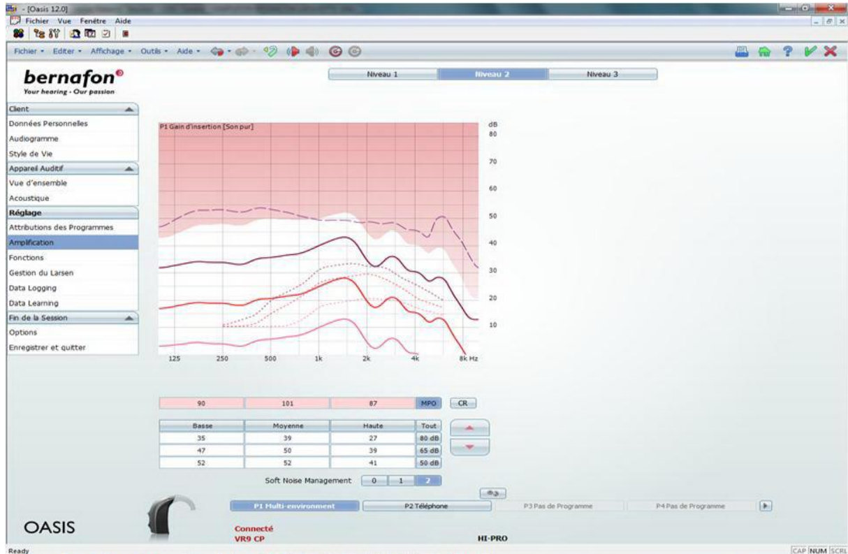
Figure (15) : Présentation du logiciel Oasis 12.0 de Bernafon présentant une baisse importante des MPO et une différence entre les valeurs de gain affichées et les courbes de gains
