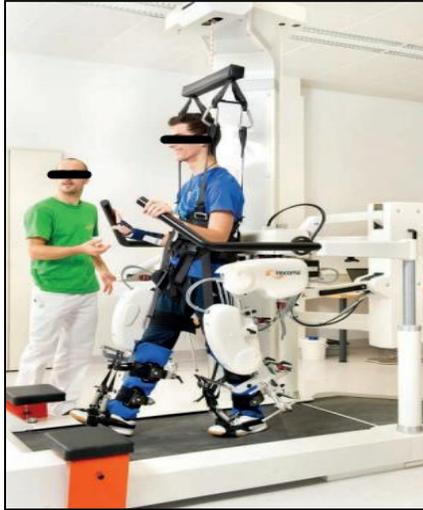
Figure 4 : Robot de marche sur tapis roulant (Médimex)
