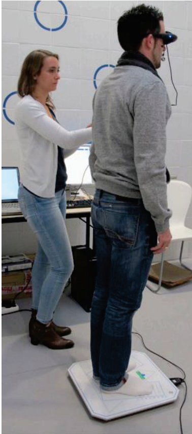
Figure 20 : Plateforme de posturographie pour analyse du contrôle postural, source : Peultier-Celli et al. (2017).
