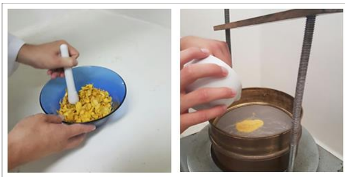
Figure 20. Mise en forme de l'extrait : trituration (à gauche), tamisage (à droite)
