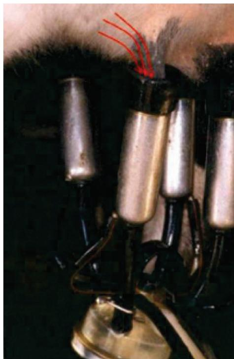
**Figure 14 : Faisceau trayeur mal branché, ce qui entraîne une entrée d'air. Source : (Enault 2008)**
