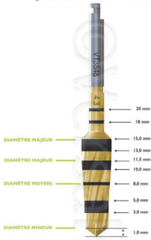
Figure 29 : Marquage laser et significations correspondantes d'un foret DENSAH – Mode d'emploi DENSAH
