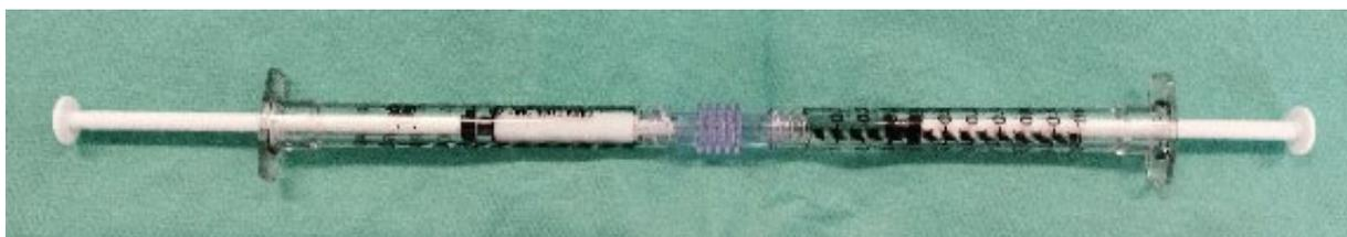
Figure 3 : Montage d'une seringue, remplie à 0,5 mL de BBS, reliée à l'aide d'un connecteur luer-lock à une autre seringue, remplie à 0,5 mL de Excipial® hydrocrème
