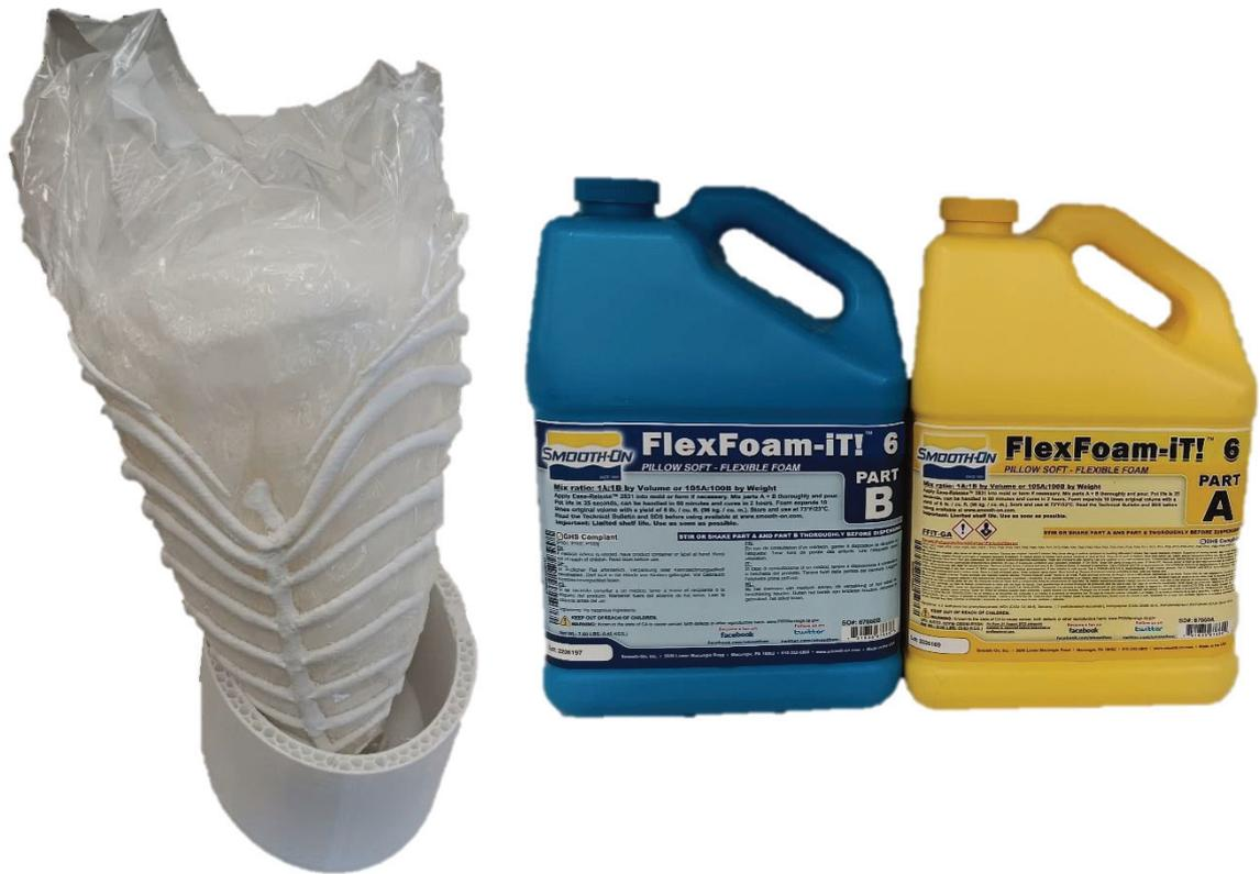
Figure 116 : Moulage de l'intérieur du thorax en mousse de polyuréthane FlexFoam-IT! 6 Pillow Soft (Meynard Clara)
