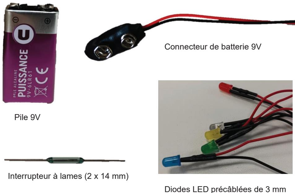
Figure 63 : Matériel de base constituant le circuit électrique (Meynard Clara)
