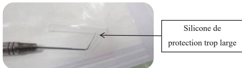
Figure 39 : Défaut instrumentation : mal protégé.
