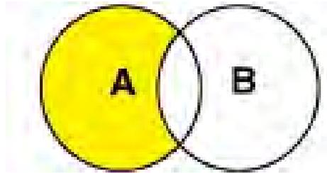
Figure 6 : Illustration de l'opérateur booléen SAUF/NOT
