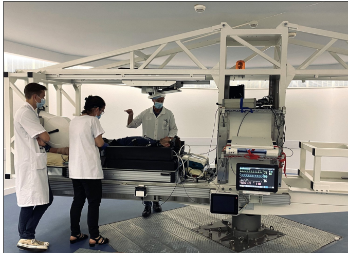
Figure 3 - Photographie de l'installation du patient dans une centrifugeuse à bras court. Tirée de MEDES : La centrifugeuse (Bernat, s. d.). http://www.medes.fr/fr/clinique-spatiale/les-equipements/la-centrifugeuse.html
