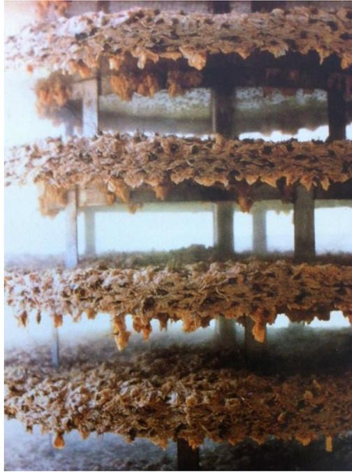
**Figure 8 - Roses de mai déposées sur les plateaux perforés d'un extracteur**
