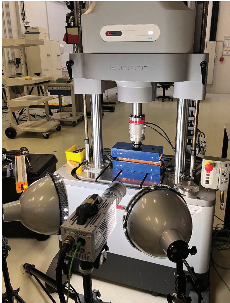
Figure 34 : Mise en place d'un échantillon sur la presse Instron
