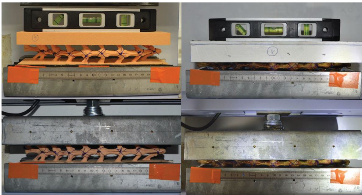
Figure 21 : Fixation des pièces à la presse et vérification de l'horizontalité avec un niveau
