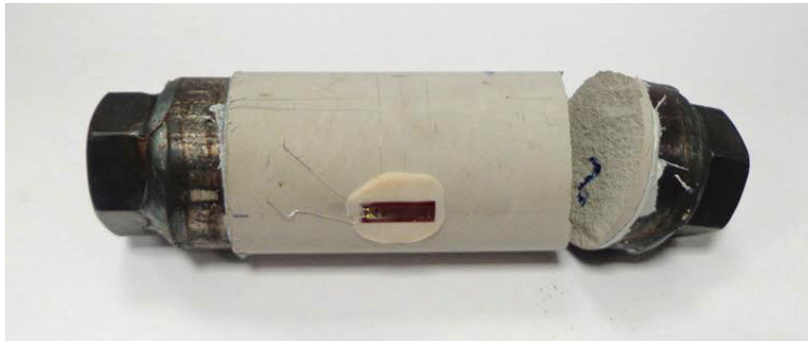
Figure 3.7 Illustration du profil de rupture en traction du matériau minéral.
