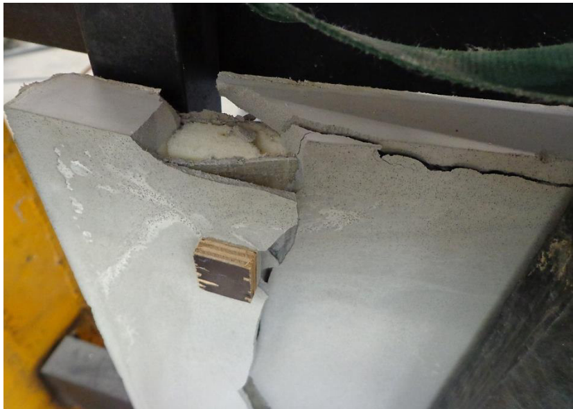
Figure 4.8 Rupture par cisaillement de la plaque 3 de la configuration BD800_20.
