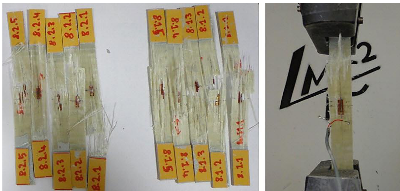
Figure 2.13 Illustration du profil de rupture en traction des peaux en GFRP.
