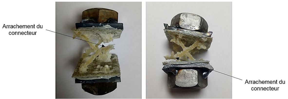
Figure 2.9 Illustration du profil de rupture en traction des connecteurs : arrachement à la jonction peaux - connecteurs.
