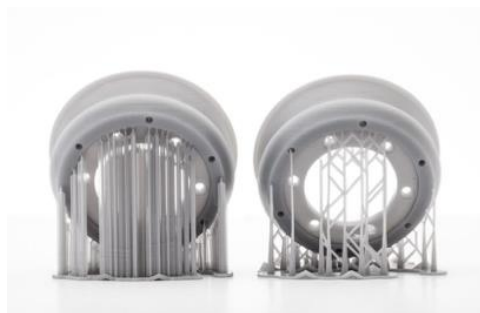
Figure 18 : Exemple de supports de construction (48)
