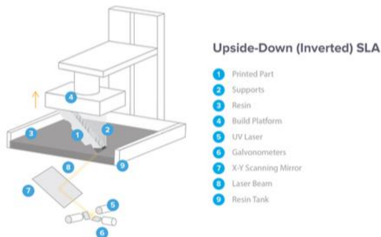
Figure 20 : Principe de fonctionnement de la stéréolithographie inversée (48)
