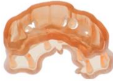
Figure 23 : Après bain d'acide et exposition UV
