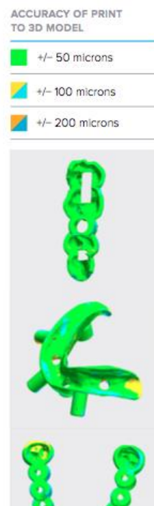
Figure 27 : Précision de l'impression des modèles (57)
