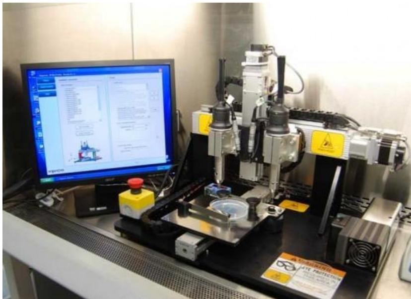
*L'imprimante Novogen MMX, capable de bio imprimer des cellules et tissus humains
