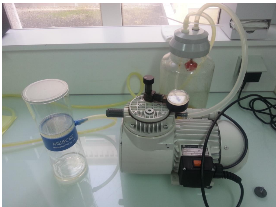
Figure 29 : Dispositif utilisé pour la filtration clarifiante de l'huile de ricin.
