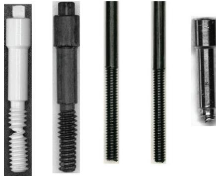
Figure 30 : Photos des échantillons après les essais de traction (82).
