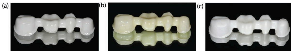
Figure 36. : Photographies montrant des armatures en zircone graduée (Verre/Zircone/Verre) avec (a) des nuances blanches et (b) jaune clair ; et une armature en zircone monolithique blanche (c) (64).
