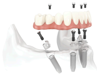
Figure 1 : Schéma du bridge complet sur implant, vissé sur des piliers multi-unit à la mandibule (6)
