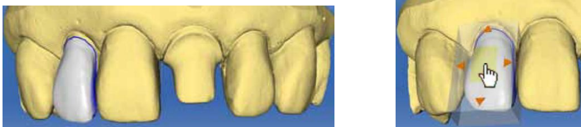
Figure 57. Par exemple, le montage proposé (à gauche) par le logiciel est ici trop long, et des concavités dans la région cervicale doivent être corrigées. La position de la facette sera alors modifiée (à droite). (ENDER, 2011) [36]
