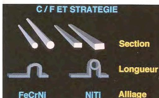
Figure 5 : Le rapport charge/flexion peut être modifié par la section du fil, sa longueur et l'alliage (SALVADORI, 2008)
