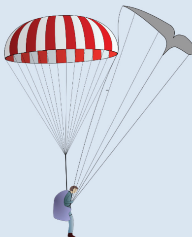
Figure 33 : Pilote en train d'utiliser un parachute de secours. Pour que son aile ne contre pas le parachute, le pilote doit s'en défaire ou la replier en tirant sur les suspentes avant.
