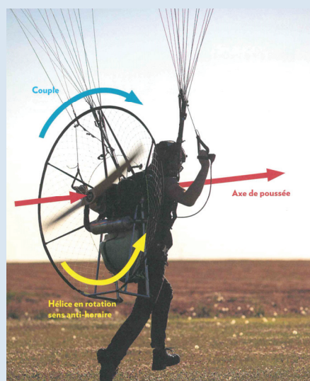
Figure 17 : Lors de la préparation au vol en paramoteur, les suspentes sont positionnées de part et d'autre du moteur (celles de gauche, à gauche, et celles de droite, à droite). Lors du gonflage, elles s'élèvent au-dessus du pilote sans toucher l'hélice. Si elles ont été mal positionnées et qu'il y a un problème lors du gonflage, une suspente peut venir toucher l'hélice (9).
