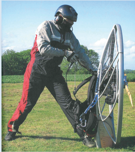
Figure 13 : Démarrage au sol d'un moteur (9). Les moteurs à essence ne sont pas tous munis de démarreur électrique. Certains pilotes démarrent leur moteur au sol pour pouvoir tirer avec plus de force sur le démarreur. Quand le paramoteur démarre au sol, il est entraîné par la poussée de l'hélice. Les accidents par contact entre l'hélice et la partie supérieure du corps sont nombreux.
