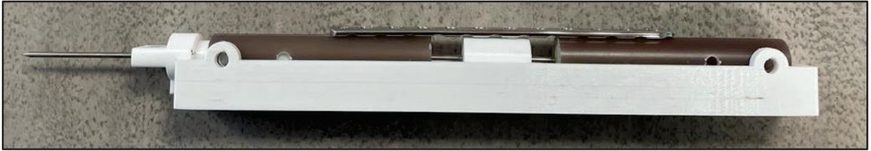
*FIGURE 19 : Perçage du trou pour la mise en place du clou. Source : MINCK Gaëtan*
