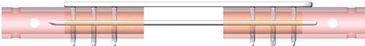
*FIGURE 20 : Schéma du montage final Clou-Plaque LCP*
