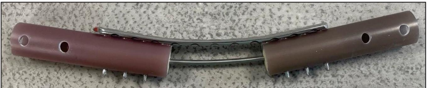
**FIGURE 38 :** Construction du clou et du MCP en fin d'essai destructif en compression. Source : MINCK Gaëtan
