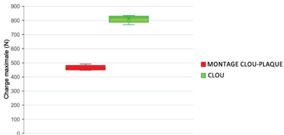
*FIGURE 31 : Box Plot de la compression des essais destructifs*
