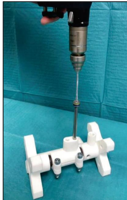
*FIGURE 15 : Guide de perçage pour les vis de la plaque du MCP (à gauche) et du clou (à droite). Source : MINCK Gaëtan*
