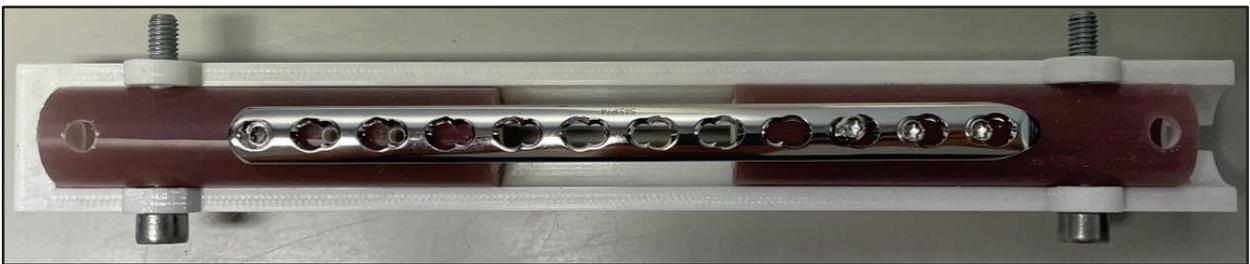
*FIGURE 17 : Mise en place des vis verrouillées. Source : MINCK Gaëtan*
