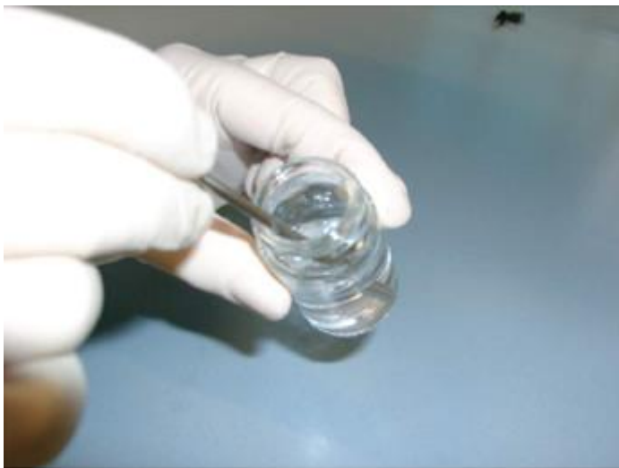
Figure 43. Agitation pour le mélange du monomère de PDMS et de son catalyseur.
