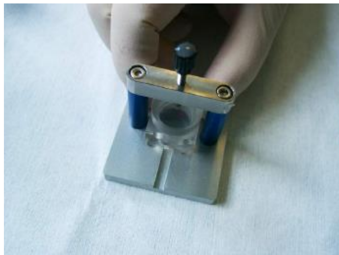
Figure 50. Pose du support du tampon sur le bloc en aluminium
