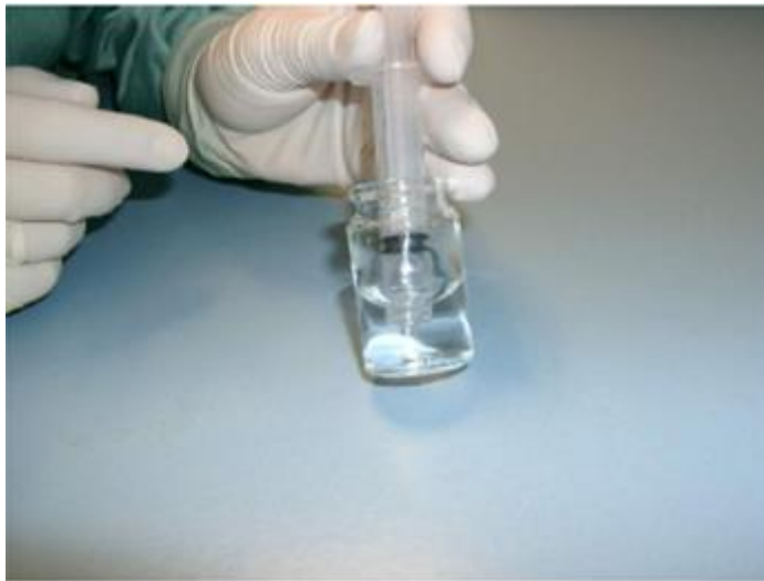
Figure 42. Prélèvement du monomère de PDMS à l'aide d'une seringue.
