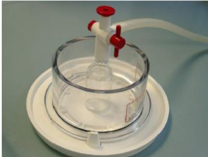
Figure 44. Dégazage du mélange de PDMS.
