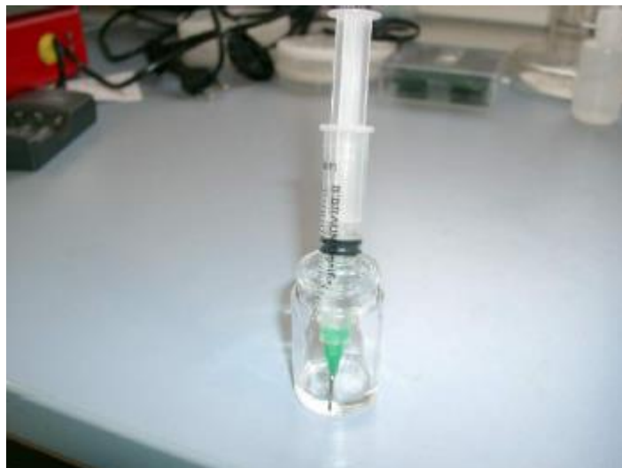
Figure 45. Prélèvement à la seringue du mélange de PDMS dégazé.
