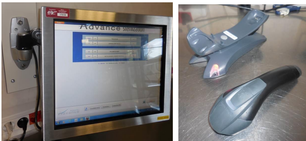
Figure 7 : Panel PC tactile et lecteur codes-barres sans fil
