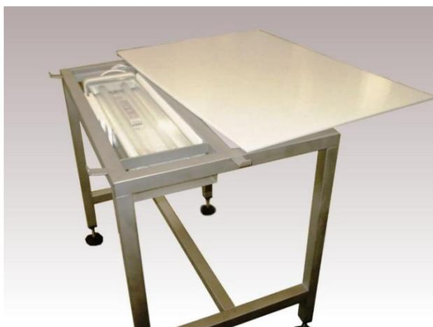
**Figure 86 : Table de mirage manuelle (Arbor technologies) (220).**
