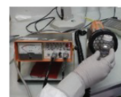
Contrôle d'un échantillon à l'aide d'un MIP 10®
