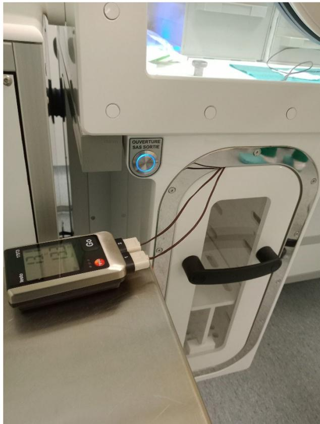
Annexe 17 : Illustration du paramétrage de l'enregistreur de température pour effectuer des mesures sur une durée de 35 minutes toutes les 20 secondes (46)
