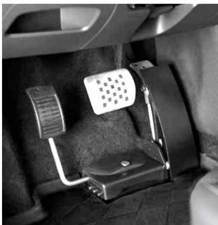
Figure 3 : Installation d'un accélérateur de pied gauche (BraunAbility Europe, 2023)
