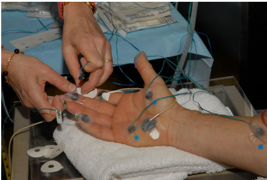
Figure 17 : Fixation des thermocouples sur les huit points de mesure de température cutanée locale
