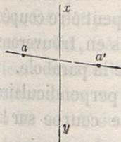
On appelle *axe de symétrie d'une ligne courbe*, ou simplement *axe*, une ligne droite par rapport à laquelle les points de cette courbe sont symétriques deux à deux.
