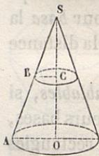
par un plan BC parallèle à sa base OA, la portion du cône comprise entre la base et la section est appelée *cône tronqué* ou *tronc de cône à bases parallèles*.
