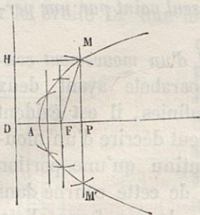
Le point  $A$  où cet axe coupe la parabole est le *sommet* de cette courbe. On appelle *paramètre* de la parabole la droite  $FD$  qui mesure la
