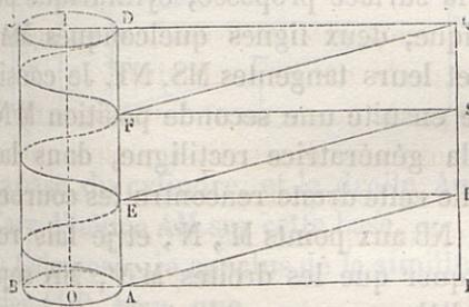
un plan la surface convexe du cylindre droit ABCD à base circulaire.
