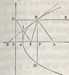
**COROLLAIRE I.** — Dans la parabole, la sous-normale PN est constante et égale au paramètre FD.
