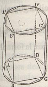
*Remarque.* — Soient  $R$  le rayon de la base d'un cylindre et  $H$  sa hauteur; le volume de ce corps est égal à  $\pi R^2 \times H$ .
