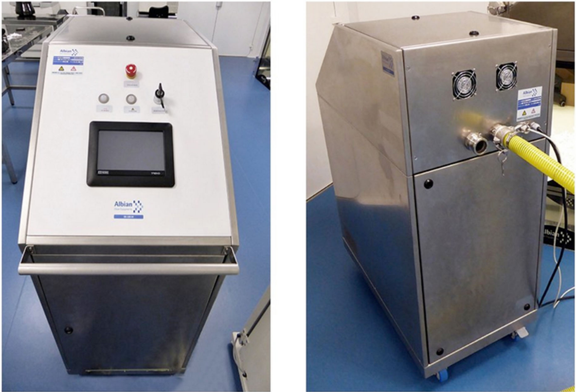
Figure 3 : Photos d'un appareil de diffusion d' \text{H}_2\text{O}_2 vaporisé
