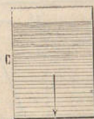
Fig. 45. — Pression sur le fond égale au poids du liquide.
