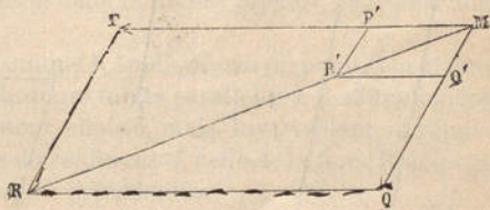
Fig. 8. — Composition de deux forces concourantes.
