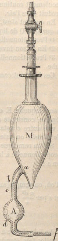
Fig. 76. — Appareil de Poiseuille pour l'étude de l'écoulement à travers un tube capillaire.
