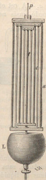
Fig. 146. — Pendule à grill.
