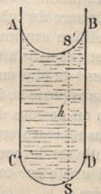
Fig. 89. — Suspension d'un liquide dans un tube capillaire.
