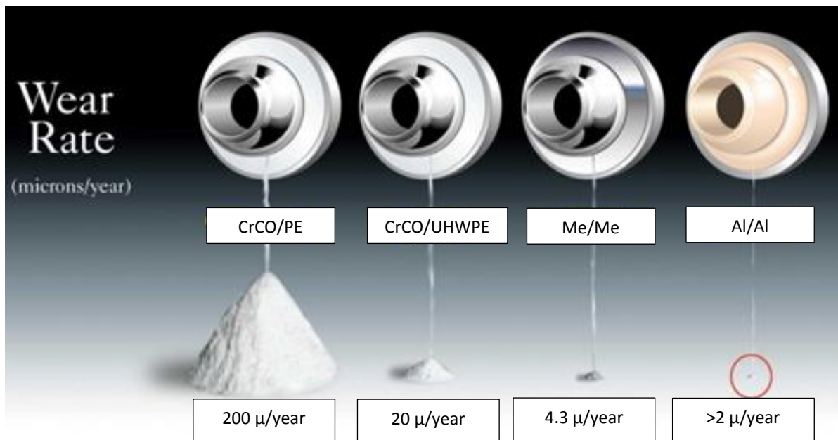
FIGURE 7 : USURE SCHEMATIQUE SELON LE COUPLE DE FROTTEMENT
