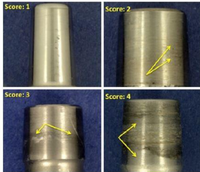
FIGURE 29 : EXEMPLE DE CLASSIFICATION DE L'ETAT DU CONE MORSE
