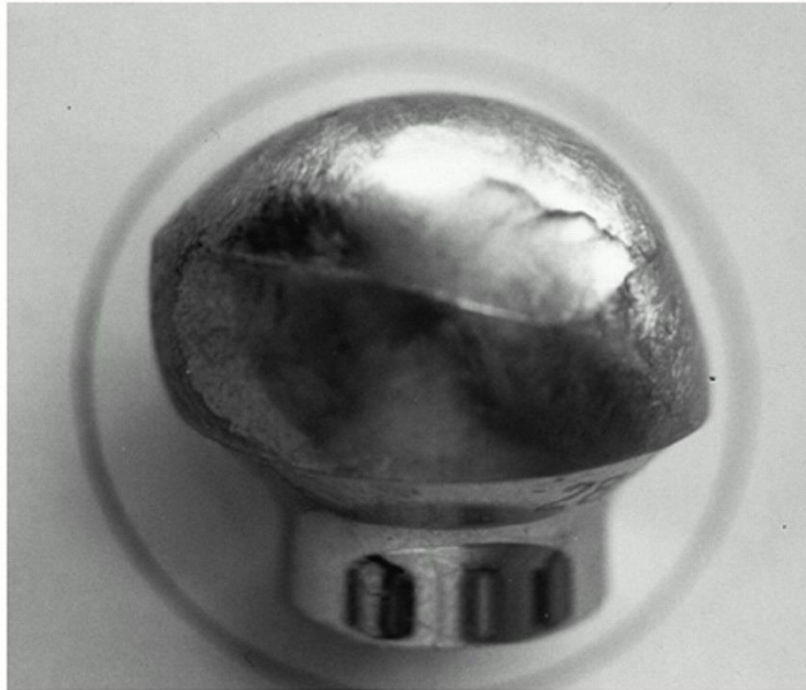
FIGURE 31 : USURE MAJEURE D'UNE TETE INOX MISE EN PLACE POUR REVISION D'UNE FRACTURE D'INSERT CERAMIQUE, D'APRES ALLAIN ET AL.(58)
