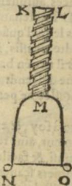
Vn autre instrument d'Agrippa. Il forgeoit deux tenailles du tout semblables l'vn à l'autre: tu vois icy en la marge l'image d'vne: KMO & LMN: les pieces d'acier sont iointes en M, alentour d'vn clou par mouuement voluble & tournoyant, & parfond vne tenaille entiere, les supremes parties KM & LM sont ainsi coniointes & assemblees, que quand elles sont contraintes, l'vne entre dedans l'autre representans la forme de vis. Entre ces parties supremes est vne corde, quand il en est besoin. Les lignes
