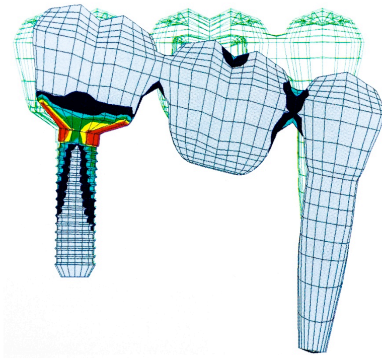
Fig 12 : Représentation des zones de stress en méthode des éléments finis. (Rangert et Renouard)
