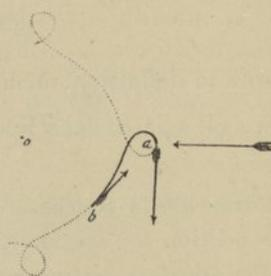
*Sens de la pression normale.* — En mettant le problème en équation nous avons supposé la pression comptée dans le sens  $\alpha + \frac{\pi}{2}$ ; elle est donc du côté de la convexité dans le voisinage du
