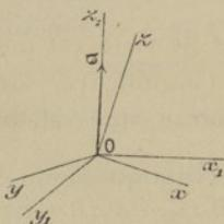
pris pour axe des  $z_1$ , la direction invariable de l'axe  $O\sigma$  du moment résultant des quantités de mouvement. Écrivons que les projections du segment  $O\sigma = l$  sur les axes mobiles sont respectivement  $Ap$ ,  $Bq$ ,  $Cr$ , nous aurons
