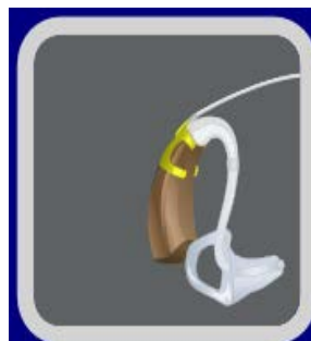
Capture d'écran, dans le logiciel STARKET, d'un dessin explicatif de la mise en place de la gaine
