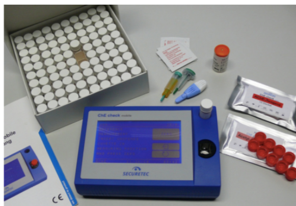
Figure 14- Composition du kit mobile ChE check pour la détermination sur site de l'activité de l'AChE et de la BChE dans le sang total (d'après Worek et al. 71 )
