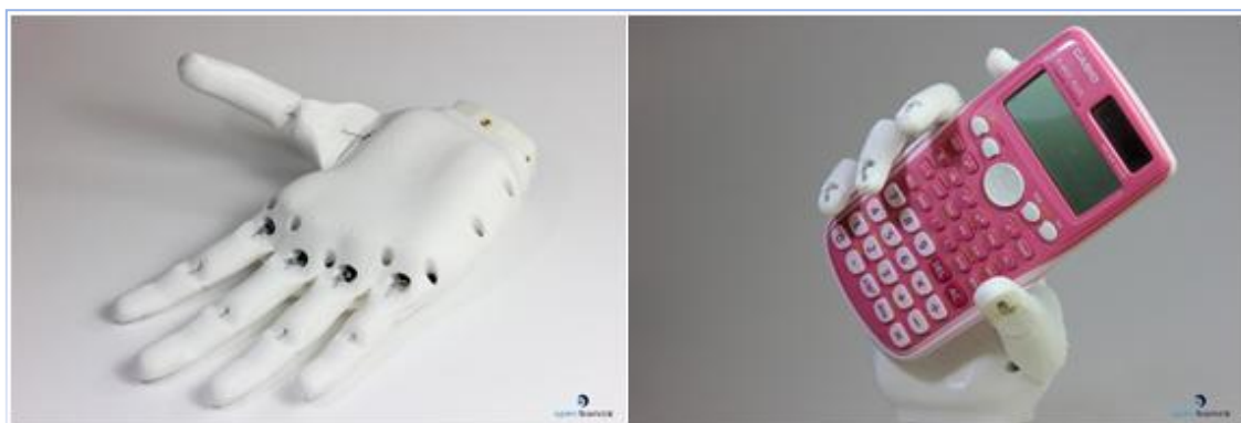
Figure 25 : La start-up britannique Open Bionics (37), fondée en 2014, développe et fabrique des mains bioniques à faibles coûts pour les amputés en utilisant la technologie d'impression 3D. Son modèle « Ada Hand » (38) coûte 500 dollars, ce qui est abordable pour une prothèse robotique contrôlée par détection de la tension des muscles et permettant de manipuler les doigts séparément (surtout l'index et le pouce). Ce concept innovant permet aux amputés de trouver une solution à faible coût pour réaliser quelques tâches de la vie quotidienne (saisie d'objets en particulier). Les designs de prothèses d'Open Bionics sont accessibles à tous en source libre afin que tout détenteur d'une imprimante 3D puisse aussi créer son propre bras bionique.
