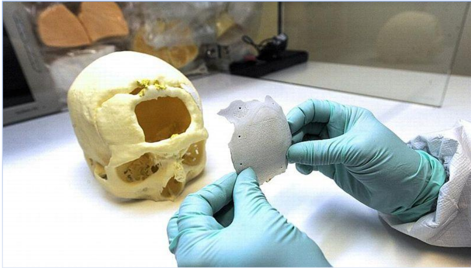
Figure 16 : prothèse présentant des centaines de micro-trous en périphérie, produit par impression 3D (25). Une société d'impression 3D et un chirurgien de Limoges ont mis un point des prothèses crâniennes ostéoconductrices en céramique, imprimées sur-mesure en 48h permettant de réduire les risques infectieux chez les patients présentant un défaut osseux.
