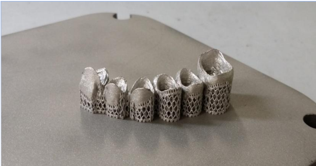
Figure 22 : Prothèses dentaires réalisées par la technologie de fusion directe de métal (33). En France, la Coopérative Technologies Dentaires utilise la technologie de fusion directe de métal par laser métal pour créer des prothèses dentaires en moins de 24 heures.
