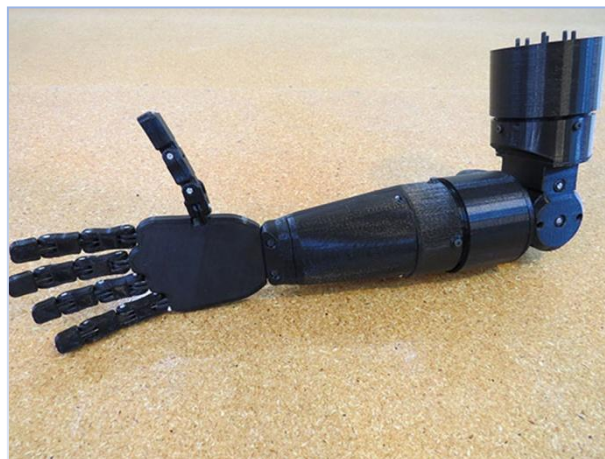
Figure 23 : L'américain Easton LaChapelle a développé une prothèse de main imprimée en 3D à un coût abordable après la rencontre avec une fillette de 7 ans à une foire scientifique dont le bras prothétique coûtait 80 000 $. Il a posté les plans en open source sur internet pour que quiconque puisse les utiliser et/ou les modifier (34).
