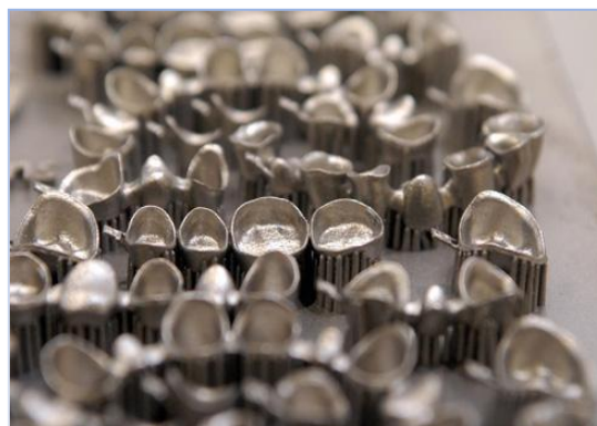
Figure 7 : Appareillages dentaires issus de la technologie SLS (11). Des prothèses dentaires sont réalisées grâce au procédé d'impression 3D par Frittage Laser Direct de Métal.
