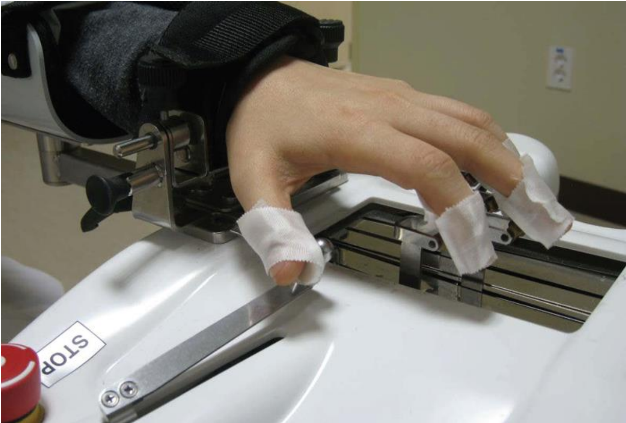
Figure 7 : Le robot permettant les mouvements synchronisés individualisés des doigts (Hwang et al, 2012).
