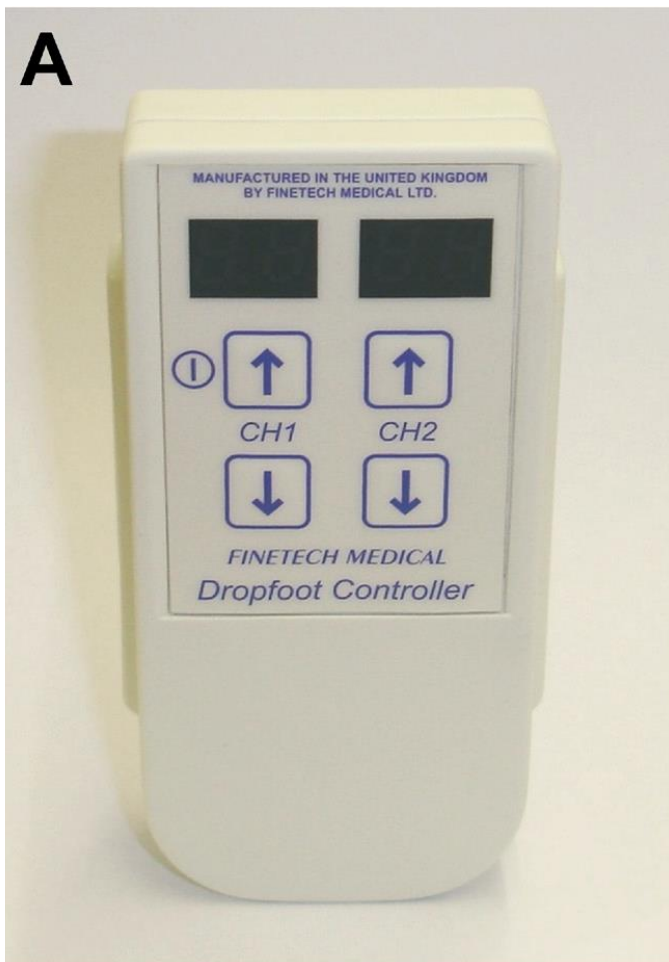
Figure 15 : (Kottink et al, 2007) Le système implantable à deux canaux de stimulation du nerf fibulaire : (A) le système externe et (B) l'implant.
