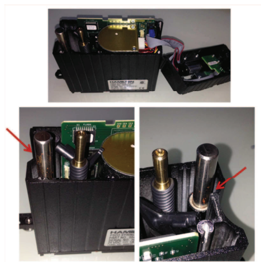
Figure 33. Fuite au niveau de la pompe de la seringue à prélèvement
