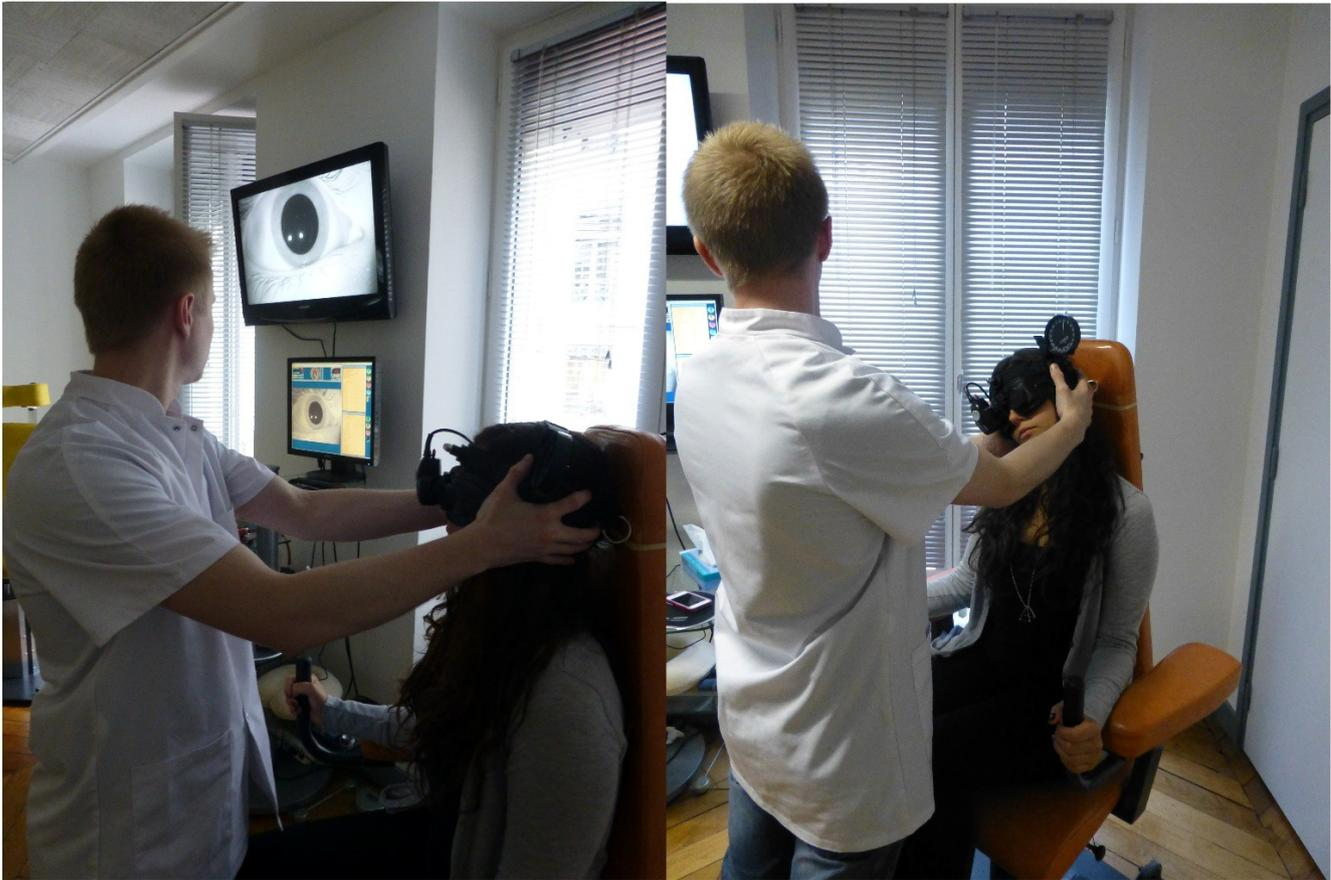
Fig.37 : Position du sujet et de l'opérateur pendant l'enregistrement de la contre rotation oculaire.
