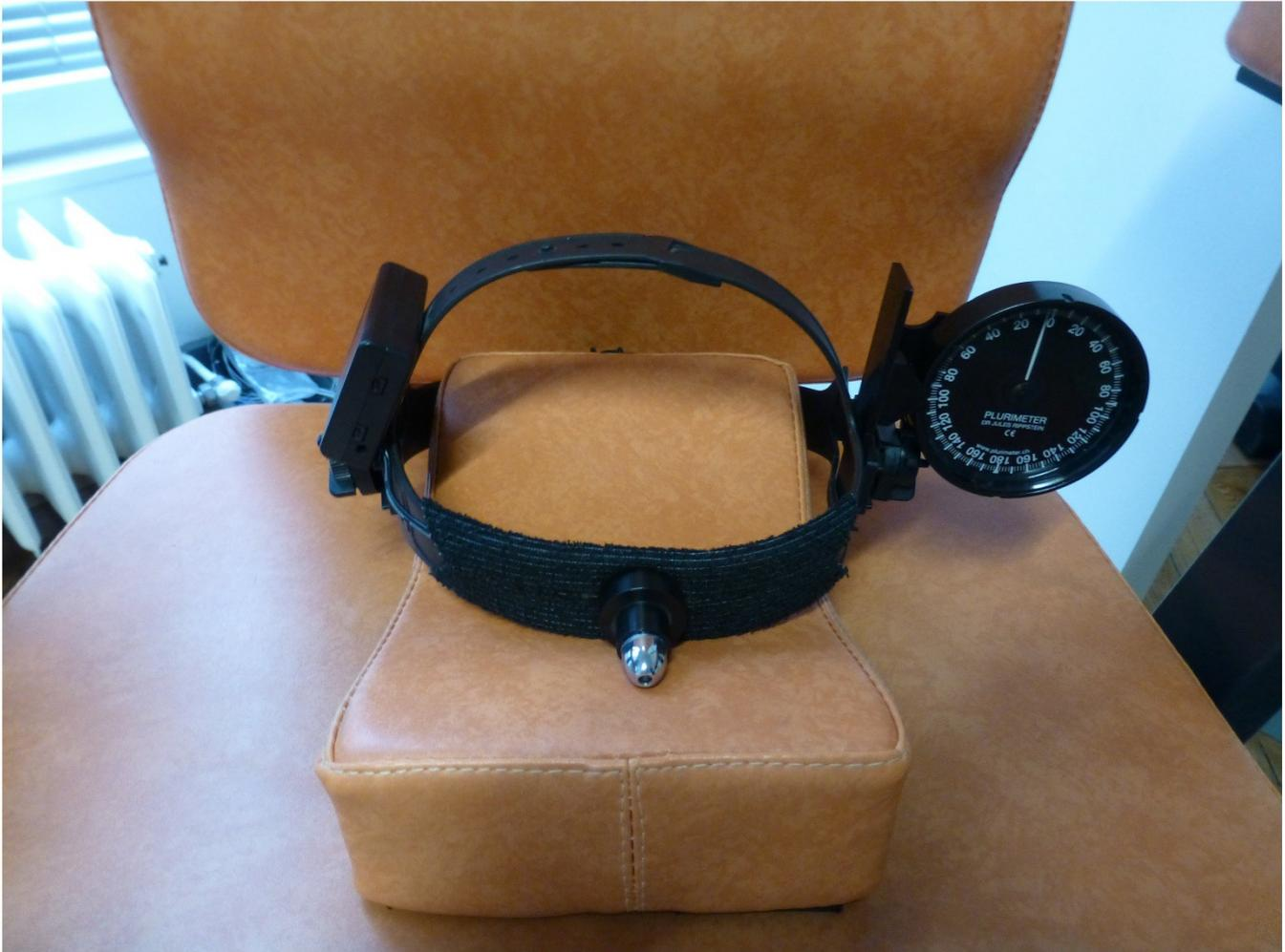
*Fig.29: Casque réglable associé à un plurimètre de Rippstein® utilisé pour mesurer l'inclinaison de la tête.*
