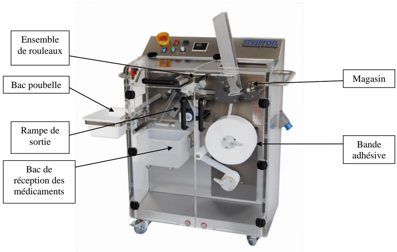
Figure 14 Machine à déconditionner STRIPFOIL® (60)
