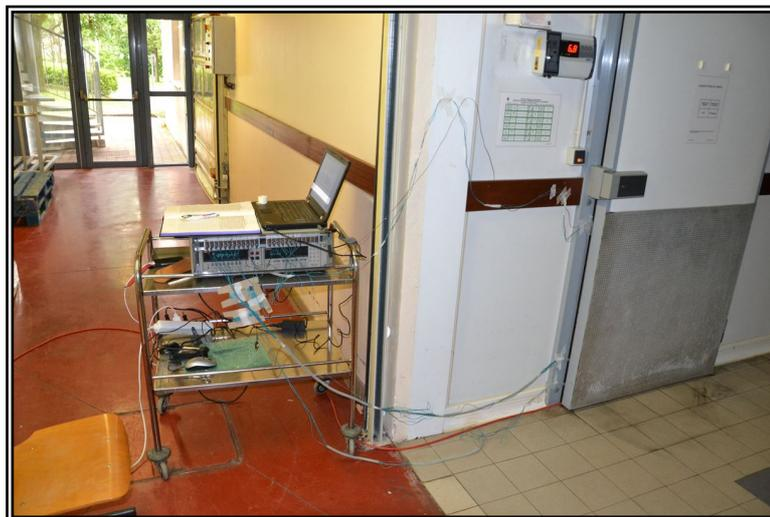
Photo 11 : Vue d'ensemble des conditions expérimentales, porte de la chambre frigorifique refermée avec centrale d'acquisition et ordinateur disposés à proximité sur un chariot.
