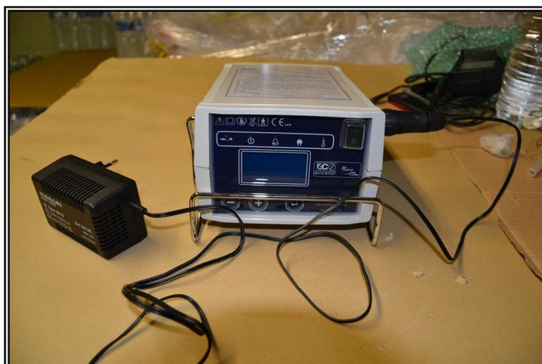
Photo 8 : Boîtier d'alimentation électrique référence BCB24-MIL pour couverture CB3-24SAMU contenant la batterie et assurant la charge de la batterie et la régulation de la température
