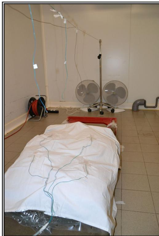
Photo 2 : Installation du brancard et du dispositif à tester dans le chambre frigorifique et les deux ventilateurs utilisés pour réaliser les conditions convectives de la 3ème étape des tests
