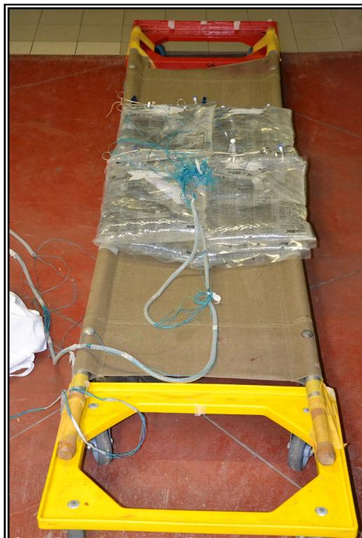
Photo 13 : Les 9 poches équipées de leur thermocouple posées sur le brancard lui-même reposant sur des plateaux à roulettes facilitant son déplacement
