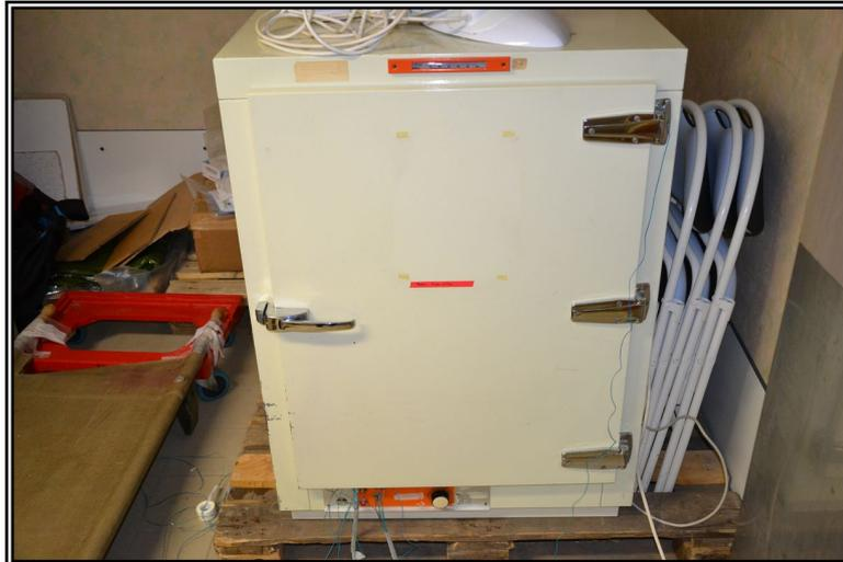
Photo 12 : Etuve utilisée pour le chauffage des poches équipées de leurs thermocouples
